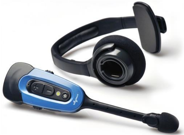
Slika 7: Primjer Pick-To-Voice uređaja za radnike u skladištu (Dostupno na: https://www.realtimelogistics.com.au/wp-content/uploads/2016/12/Vocollect-SRX2.jpg , 17.7.2018.)
