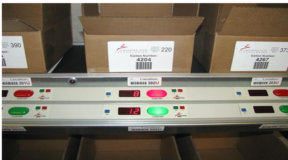
Slika 6: Primjer Pick-To-Light uređaja u skladištu (Dostupno na: http://www.bpcontrols.com/images/ptl-photo1.jpg , 12.7.2018.)
