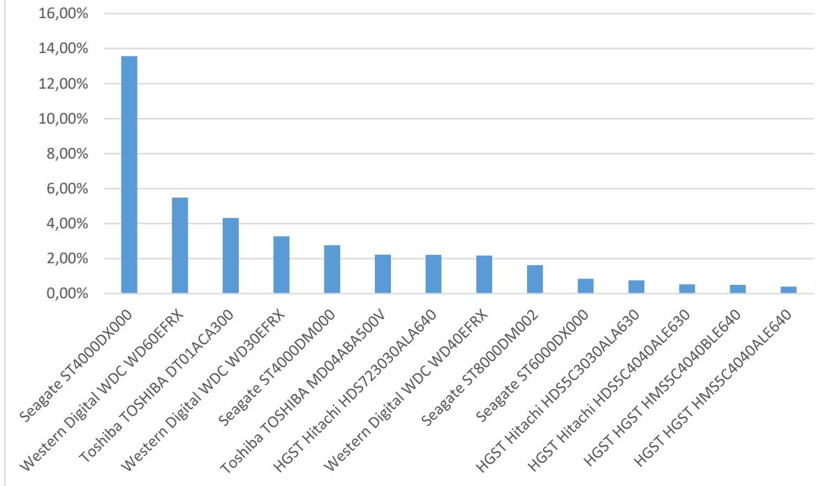
Slika 5: Grafički prikaz učestalosti ispada diskovnih jedinica 1.1 2016. - 31.12.2016.
