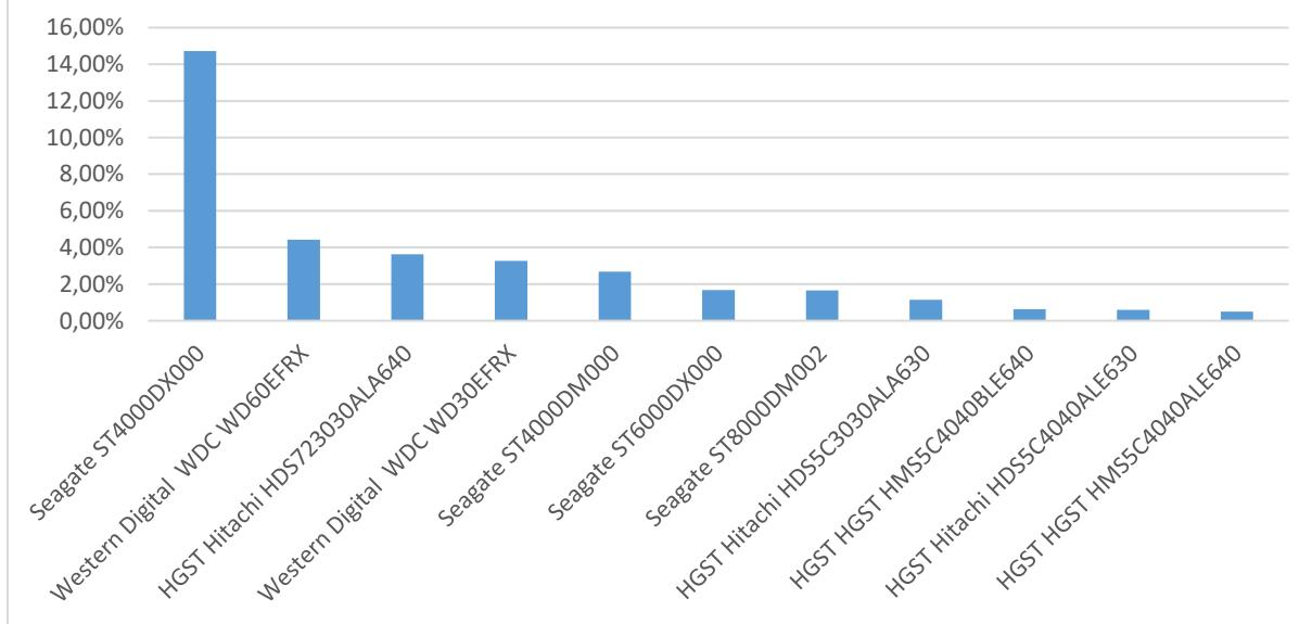
Slika 4: Grafički prikaz učestalost kvarova modela tvrdih diskova u Q4 2016.
