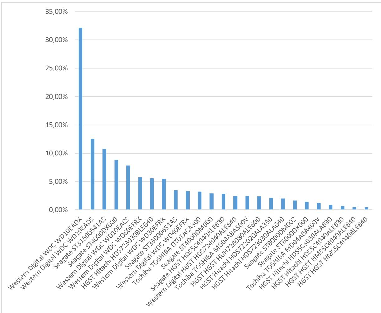
Slika 6: Grafički prikaz učestalost ispada diskovnih jedinica 1.1 2015. - 31. 12.2016.
