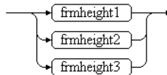
Slika A.28 Sintaktički dijagram produkcijskog pravila frmheight
