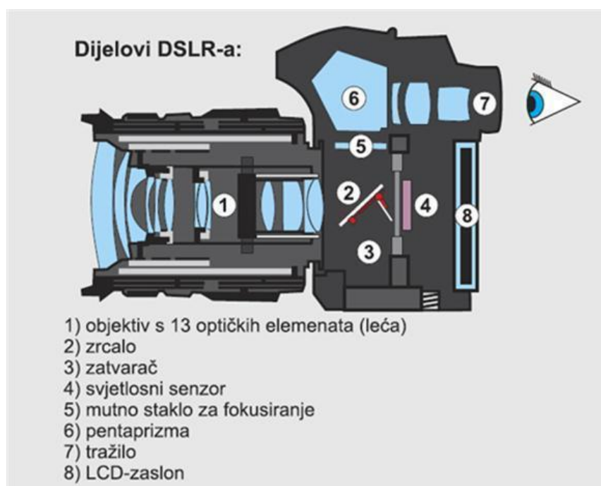
Slika 6: Dijelovi DSLR fotoaparata
