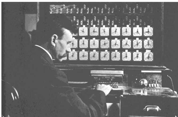
Slika 2: Tabulirajući stroj Hermana Holleritha
