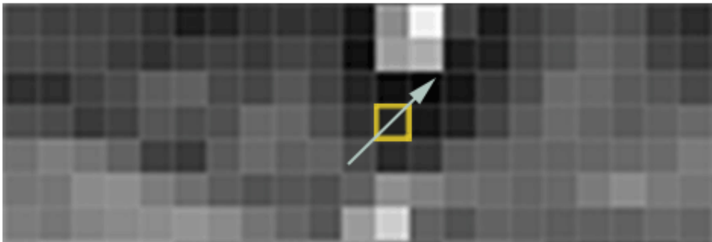
Slika 13: Detekcija smjera tamnijeg susjednog piksela [23]
