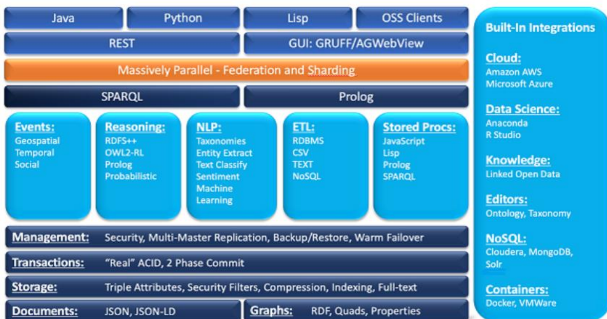
Slika 9, Arhitektura AllegroGraph sustava (Izvor:
