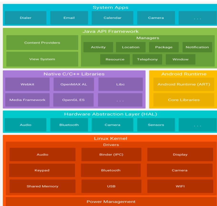
Slika 1 Arhitektura Android platforme (izvor: <https://developer.android.com/guide/platform>, 2020.)
