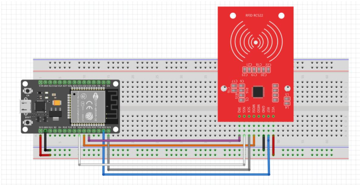
Slika 32: Shema spajanja - ESP32 i RFID-RC522 senzor
