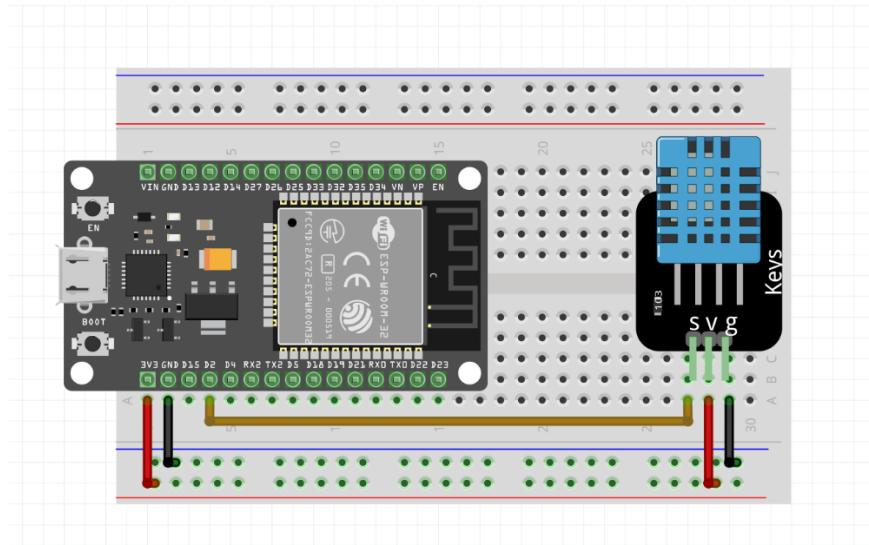
Slika 30: Shema spajanja - ESP32 i DHT11 senzor
