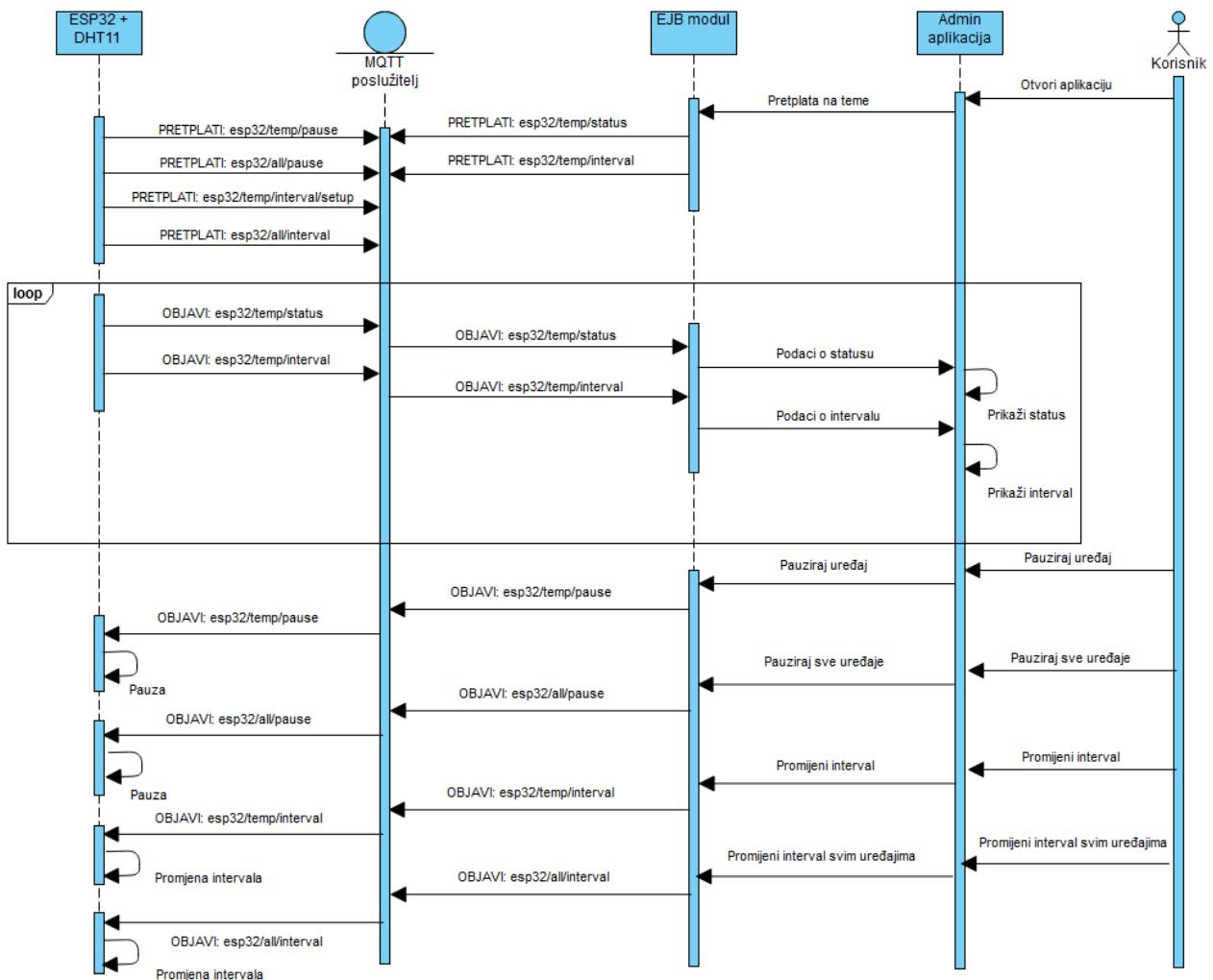
Slika 24: Dijagram slijeda aktivnosti - Upravljanje IoT uređajem
