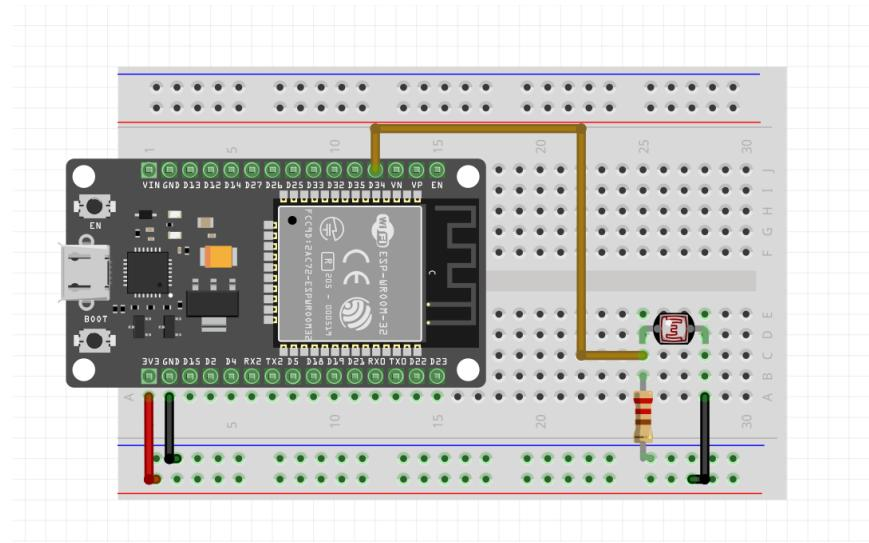
Slika 31: Shema spajanja - ESP32 i svjetlosni senzor
