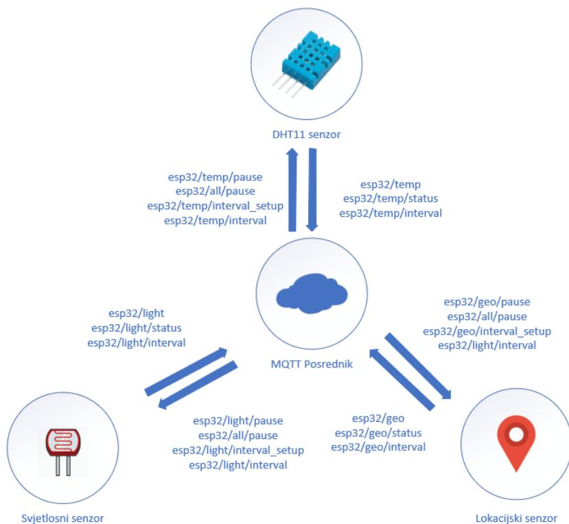
Slika 33: Način komunikacije IoT uređaja i MQTT posrednika
