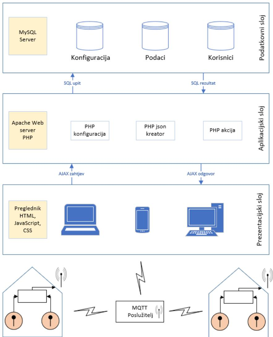
Slika 11: Arhitektura sustava temeljenog na MQTT porukama [21]
