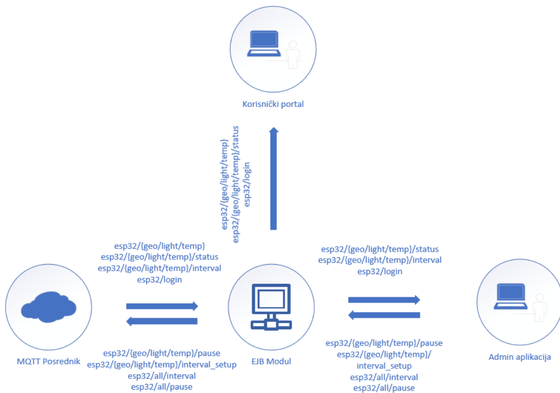
Slika 34: Način komunikacije EJB modula, MQTT posrednika i aplikacija
