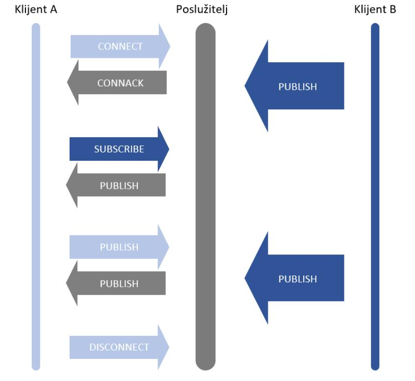
Slika 5: Proces razmjene poruka pomoću MQTT protokola
