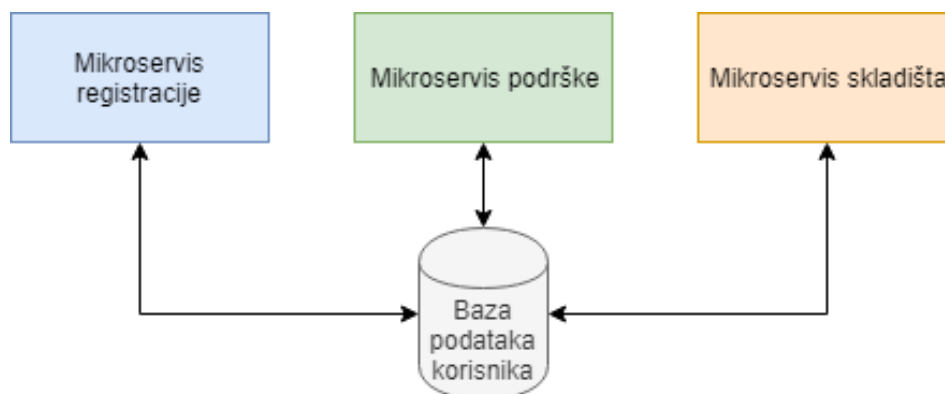
Slika 16 Prikaz integracije s dijeljenom bazom podataka[5]
