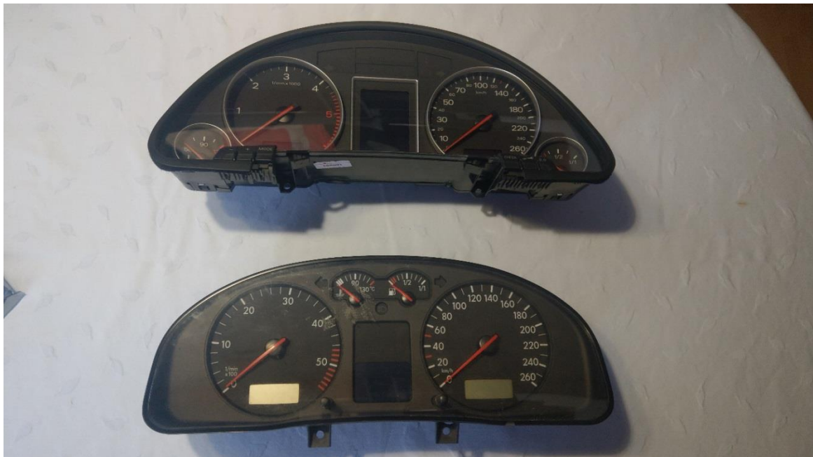
Slika 4: Imobilizator (integrirani, gore: Audi, dolje: VW)
