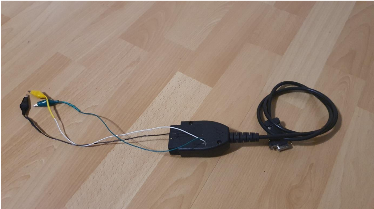
Slika 15: OBDII kabel za direktno spajanje na CAN sabirnicu
