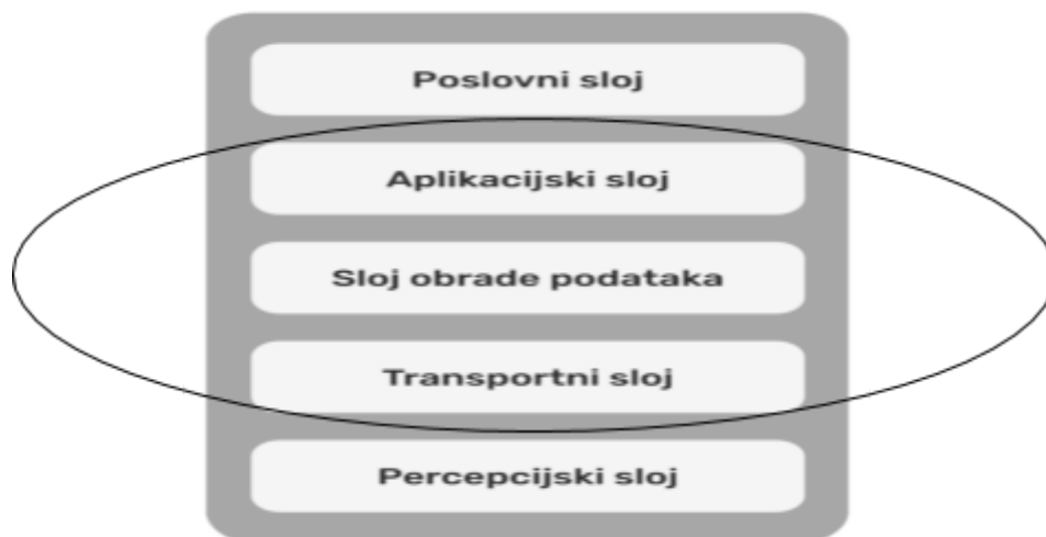
Slika 5. Slojevi koje obuhvaća lokalna upravljačka jedinica u rubno - centričnoj arhitekturi interneta stvari (Izvor: Autor izradio prema [21])
