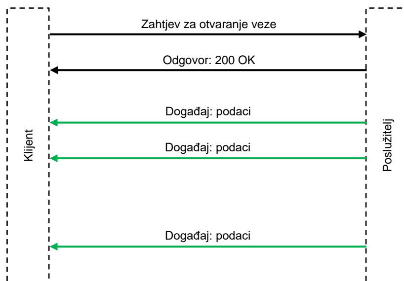
Slika 7: Prikaz komunikacije klijenta i poslužitelja tehnikom Server-Sent Events
