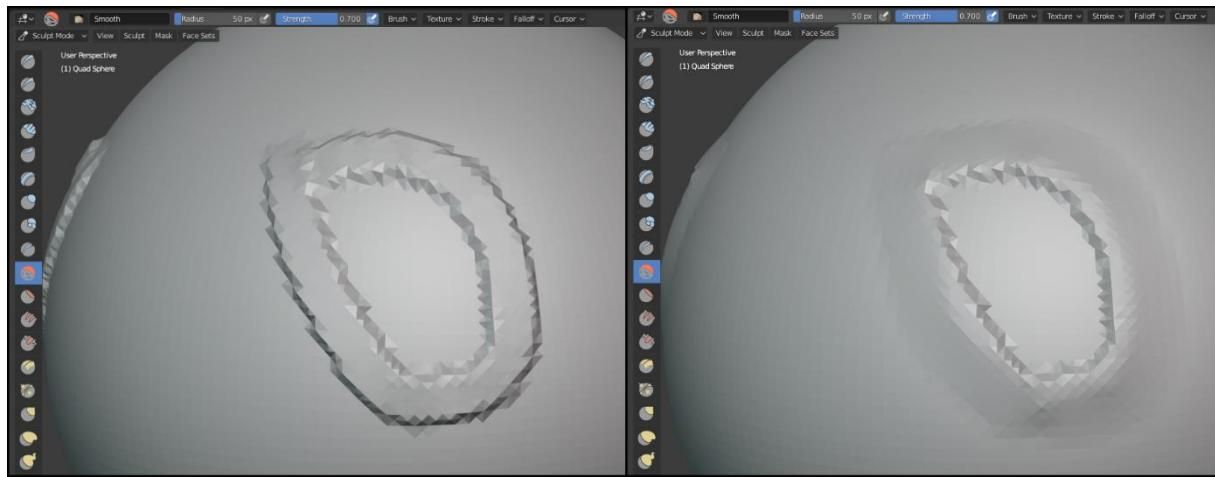
Slika 34 - Primjer kista uglađivanja. Lijevo je stanje prije, a desno nakon korištenja kista uglađivanja
