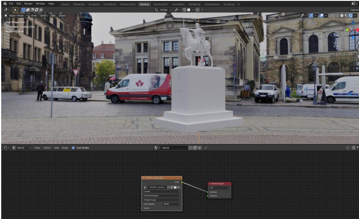
Slika 82 - Korištenja HDRI za osvjetljenje scene. Izvor [13]
