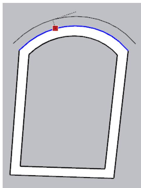
Slika 20: 'Offset' funkcionalnost, pomak linije. Izvor: vlastita izrada
