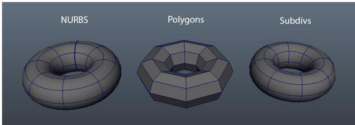
Slika 3: Razlika osnovnih pristupa 3d modeliranja, Izvor:
