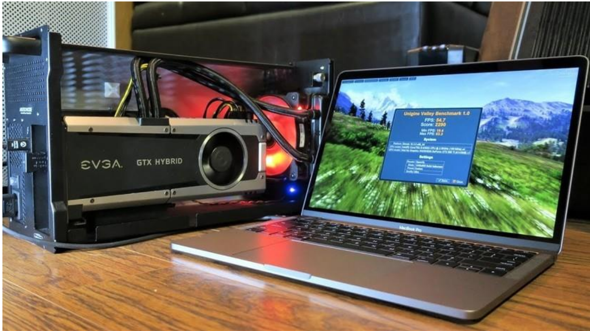
Slika 7 Eksterna grafička kartica (Izvor: https://www.imore.com/how-set-your-mac-external-gpu , 2017)
