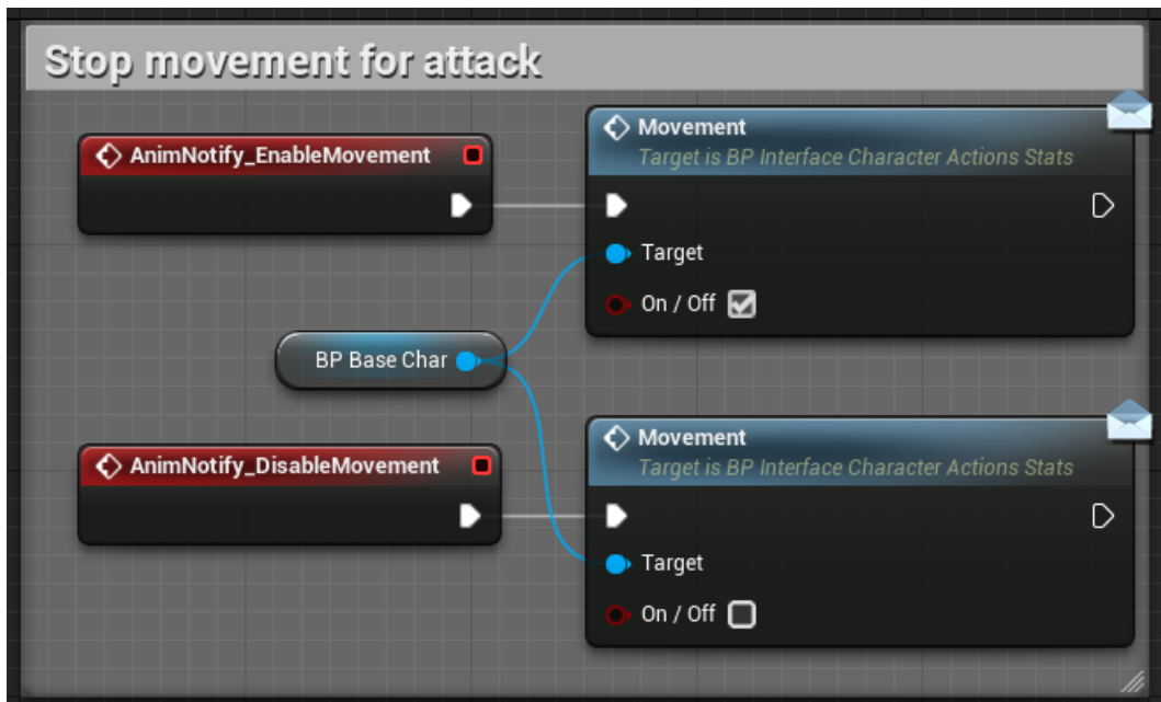
Slika 35: Zaustavljanje kretanja uz pomoć notifiera (Izvor: vlastita slika iz alata)
