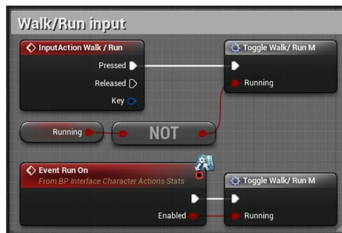
Slika 14: Logika pritiska tipke za trčanje/hodanje (Izvor: vlastita slika iz alata)
