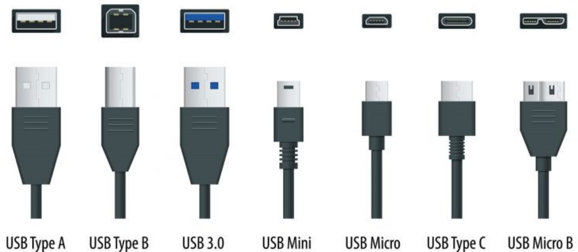
Slika 12: Tipovi USB konektora [31]
