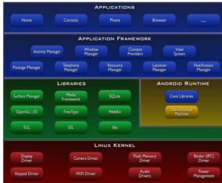
Slika 1: Android OS arhitektura (Izvor: http://android-pit.blogspot.com/2012/01/arhitektura-androida.html )
