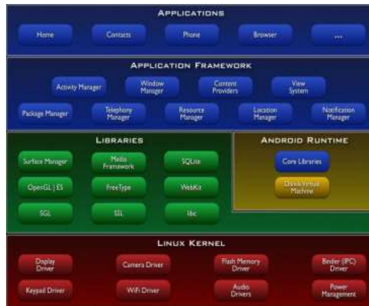
Slika 1: Android OS arhitektura (Izvor: http://android-pit.blogspot.com/2012/01/arhitektura-androida.html )
