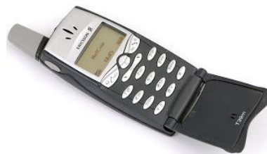
Slika 3 Prvi mobilni uređaj s Bluetooth tehnologijom (Peter, 2021)
