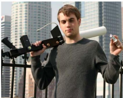
Slika 11 Uređaj za izvođenje BlueSniping napada (CARNet CERT i LS&S, 2009)
