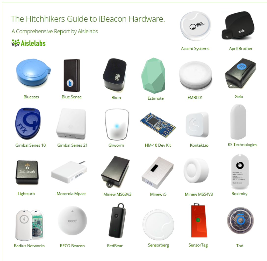
Slika 1: BLE Odašiljači različitih proizvođača (Izvor: Aislelabs, 2015)
