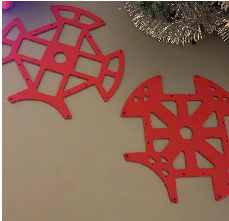
Slika 21. Isprintani dijelovi šasije
