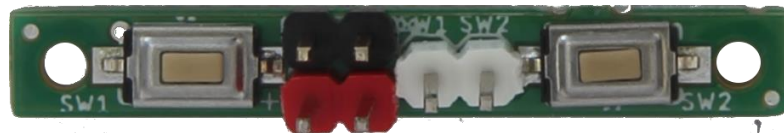
Slika 10. Tipkalo „MRMS switch 2x“ [13]
