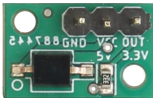
Slika 4. Senzor za boju „MRMS Reflectance Sensor A“ [7]
