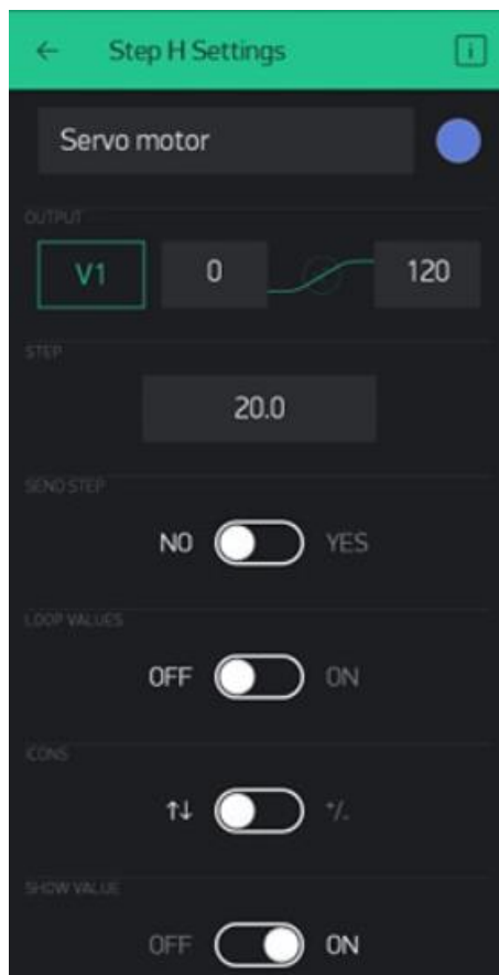
Slika 9: Snimka zaslona – Postavke Steper gumba (aplikacija Blynk)
