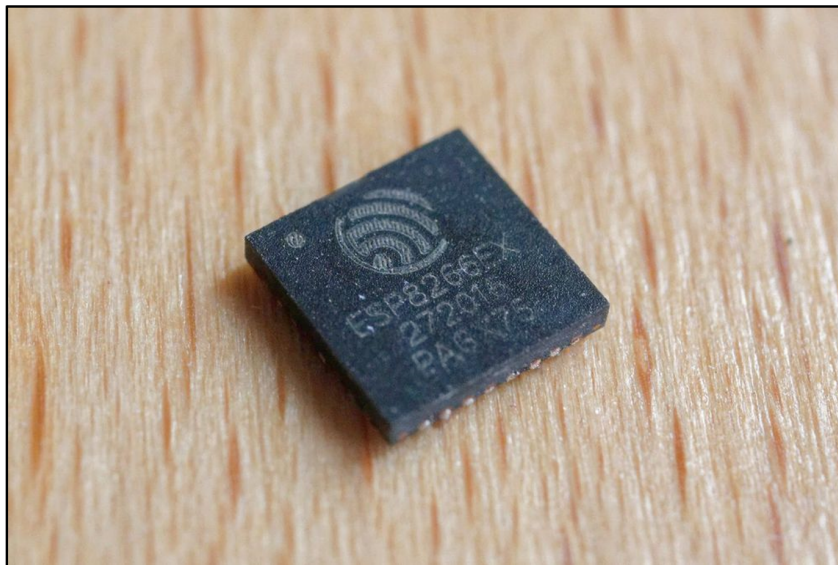
Slika 6: ESP8266 mikrokontroler (Izvor: preuzeto s [11])
