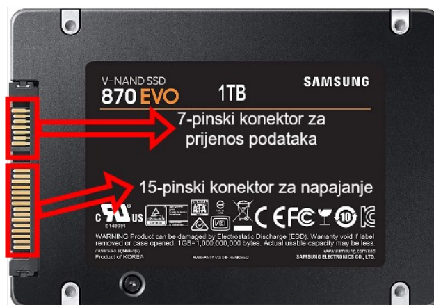
Slika 13. Primjer SSD-a sa SATA sučeljem (Prema: jeftinije.hr, (bez dat.))
