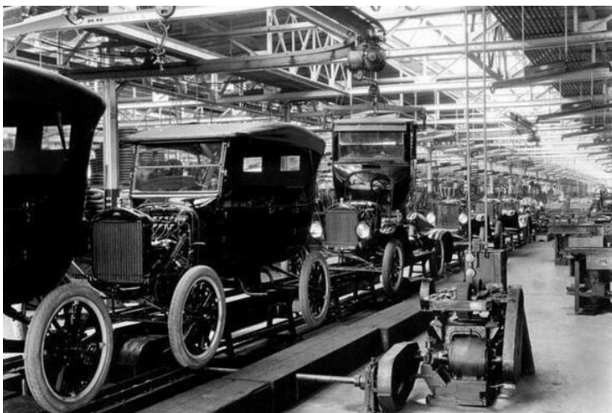
Slika 1: Proizvodna linija Forda Model T (Flickr, 2014.)
