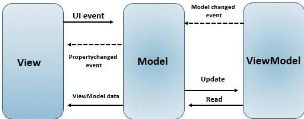
Slika 1 Komponente "MVVM" arhitekture sustava
