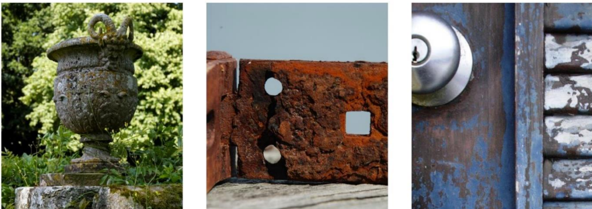
Slika 44: Primjer biološkog trošenja materijala (lijevo), primjer kemijskog trošenja materijala (sredina), primjer mehaničkog trošenja materijala (desno) (Parsons, 2017, str. 4)
