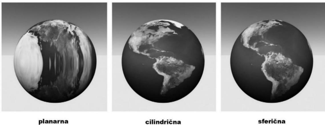
**Slika 3:** Planarna, cilindrična, i sferična projekcija (Chopine, 2011, str. 152)
