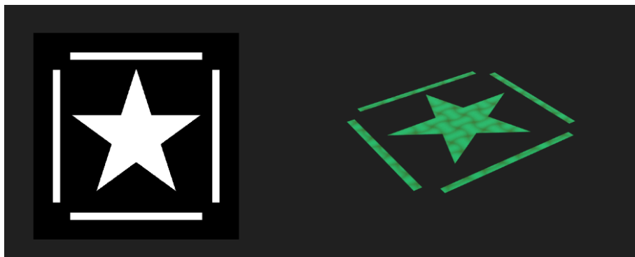
Slika 20: Primjer alpha mape (lijevo) i njena manifestacija na površini (desno) – bijeli dijelovi otkrivaju albedo mapu iz prethodnog primjera (autorski rad)
