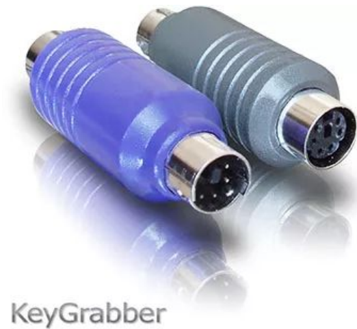
Slika 11: Hardverski PS/2 keylogger poduzeća Keelog [40]
