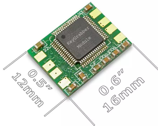
Slika 9: Ugradbeni keylogger USB sklop poduzeća Keelog [38]
