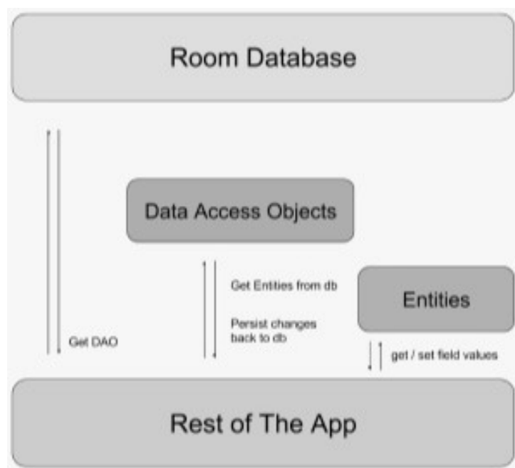
Slika 16: Android Room arhitektura, [14]
