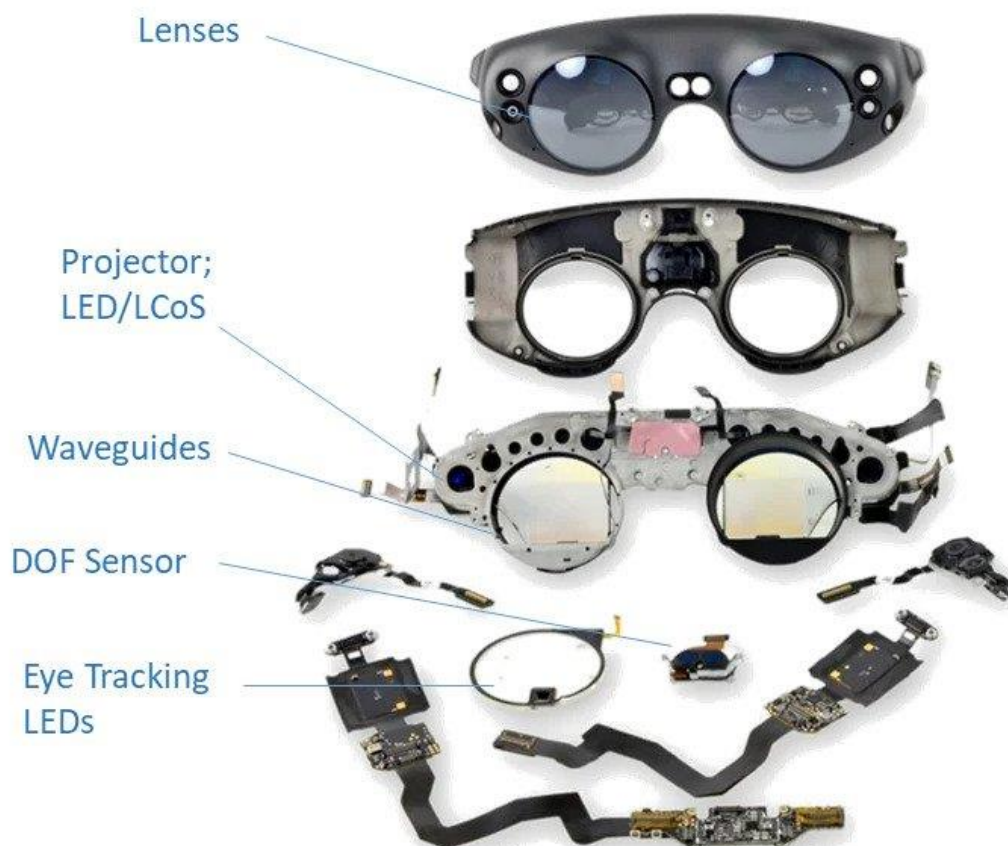
Slika 10 Prikaz interne strukture uređaja sa sensorima za praćenje očiju [slika] (bez dat.) Dostupno: https://d36nggmw98g4v5.cloudfront.net/image-handler/ts/20220308110625/ri/723/src/images/Article_Images/ImageForArticle_2166_16467_987826333977.png [pristupano: 22.8.2023.]
