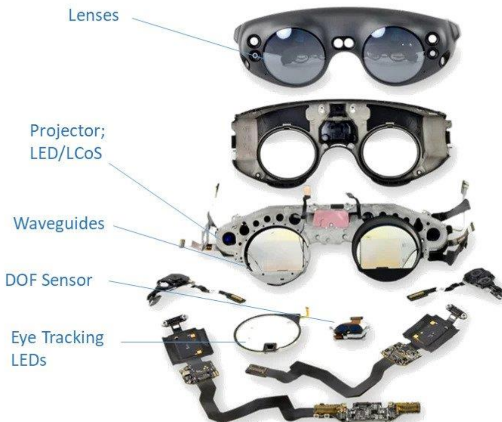
Slika 10 Prikaz interne strukture uređaja sa sensorima za praćenje očiju [slika] (bez dat.) Dostupno: https://d36nggmw98g4v5.cloudfront.net/image-handler/ts/20220308110625/ri/723/src/images/Article_Images/ImageForArticle_2166_16467_987826333977.png [pristupano: 22.8.2023.]
