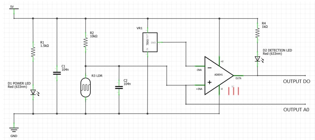
Slika 6: Shematski prikaz LDR senzora (Izvor: autor, 2023)
