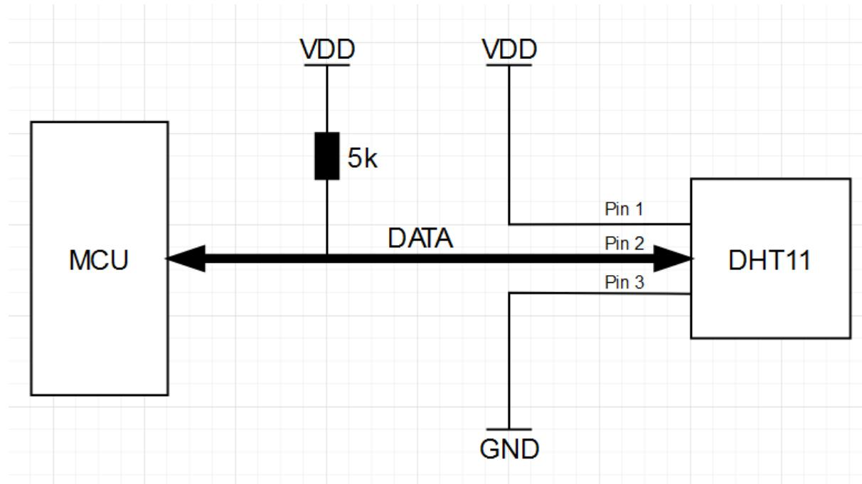
Slika 5: Shematski prikaz DHT11 senzora (Izvor: autor, 2023)
