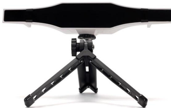
Slika 14: Gazepoint GP3 uređaj za praćenje očiju (Izvor: Gazepoint, bez dat.)
