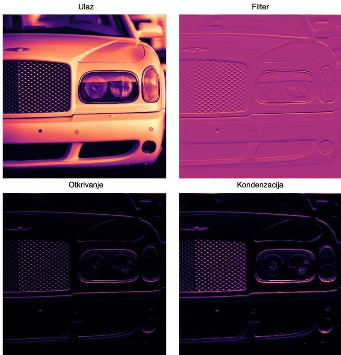
Slika 6: Primjer konvolucije ulazne slike (Vlastita izrada prema: https://i.imgur.com/IYO9lqp.png )
