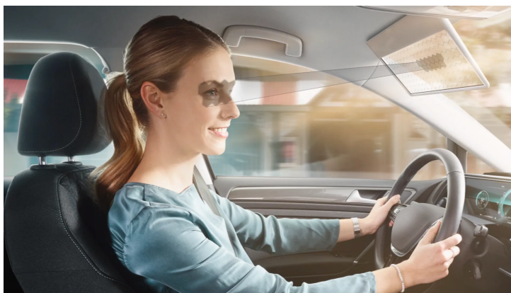
Slika 3: Ilustrativni prikaz za Boschov LCD vizir [2]
