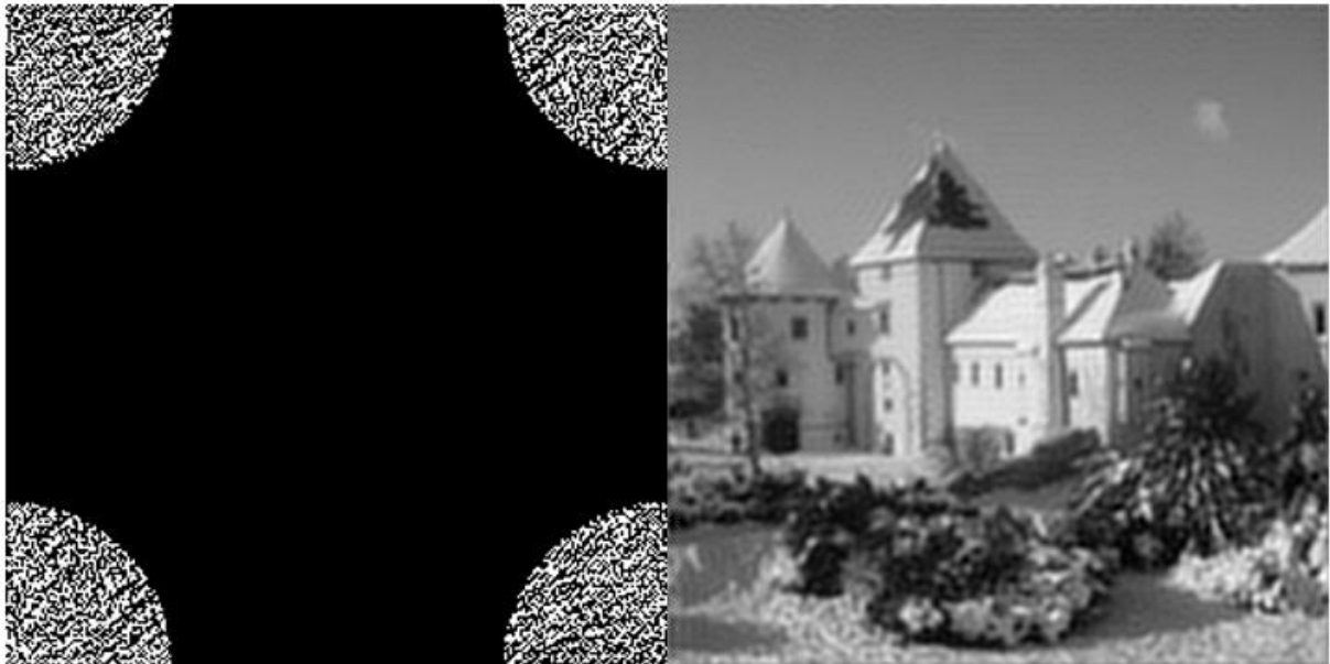
Slika 62: Rezultat primjene nisko-frekvencijskog filtera postavljenog na 50% (snimka zaslona) [autorski rad]
