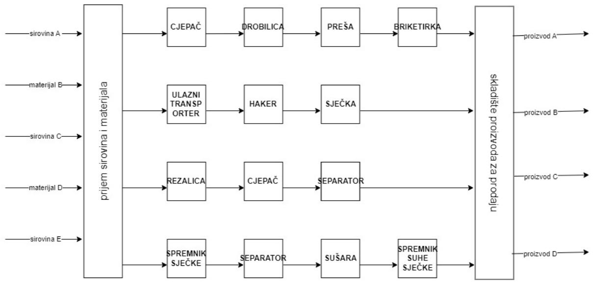
Slika 2: Linijski raspored opreme s više proizvodnih linija (Prema: Sikavica, 2011)
