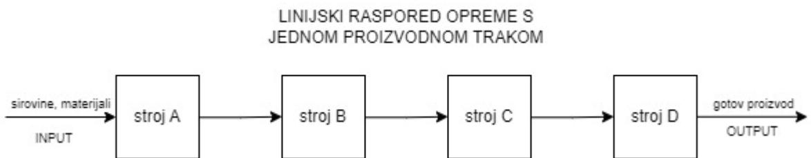
Slika 1: Linijski raspored opreme s jednom proizvodnom trakom (Prema: Sikavica, 2011)
