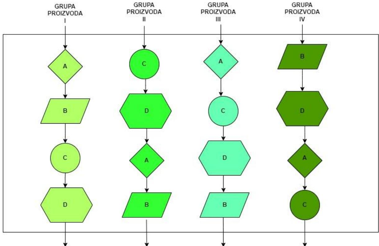
Slika 6: Raspored opreme po načelu grupne tehnologije (Prema: Sikavica, 2011)
