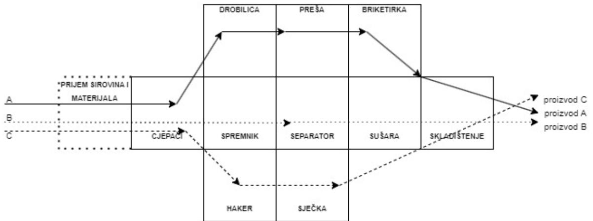
Slika 3: Grupni (procesni, radionički) raspored opreme (Prema: Sikavica, 2011)
