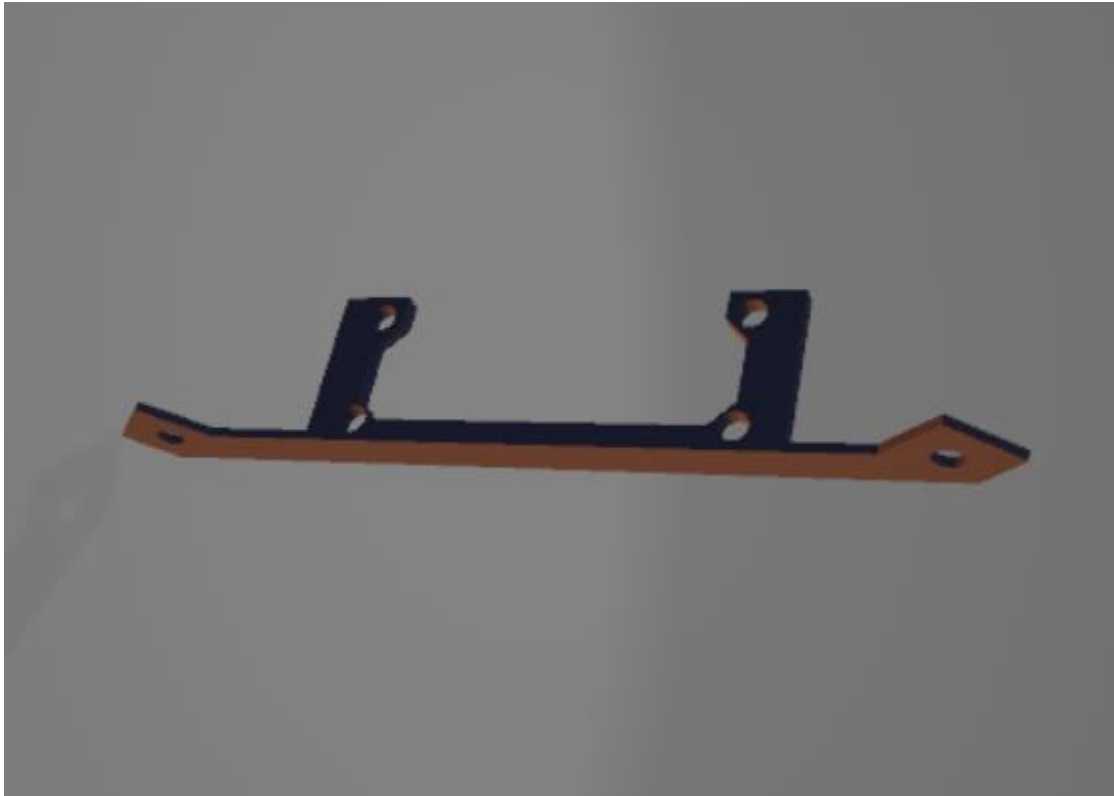
Slika 27. 3D model držača ultrazvučnih senzora [Iz vlastite izrade]
