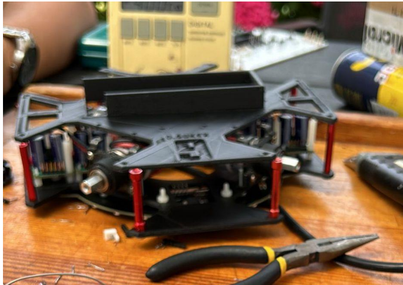
Slika 32. Spajanje gornje i donje šasije prilikom izrade robota [Iz vlastite izrade]
