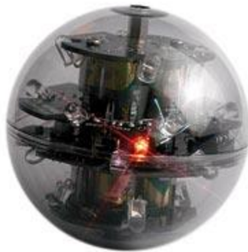
Slika 1. IR lopta korištena na RCJ natjecanjima
