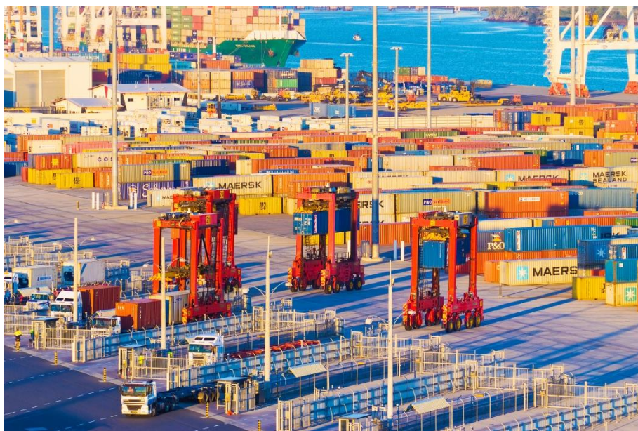
Slika 5. Kalmar AutoStrad - Patrick Terminals u Australiji (Izvor: Heavy Lift News, 2020)
