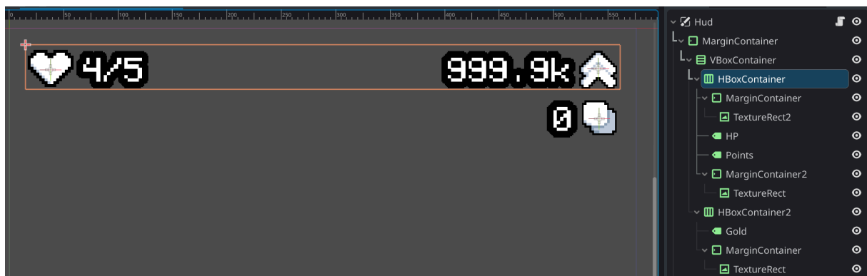
Slika 27: Prikaz primjera HUD sučelja sa spremnicima
