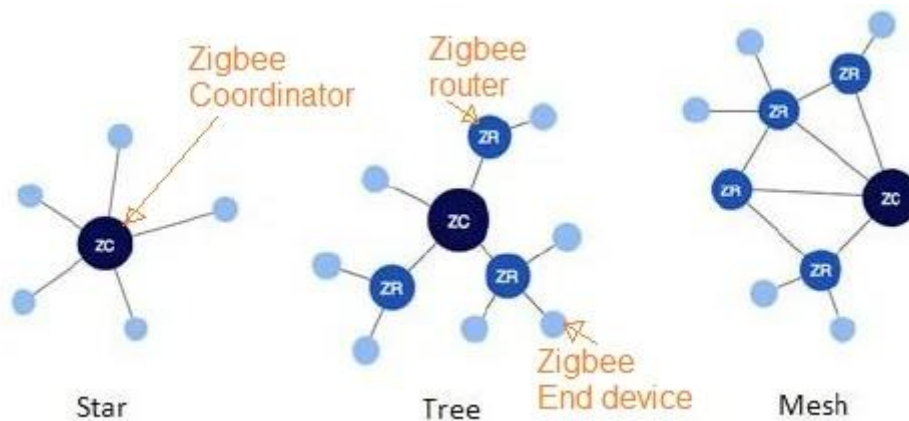
Slika 3. Različite topologije Zigbee mreža (Izvor: [11])
